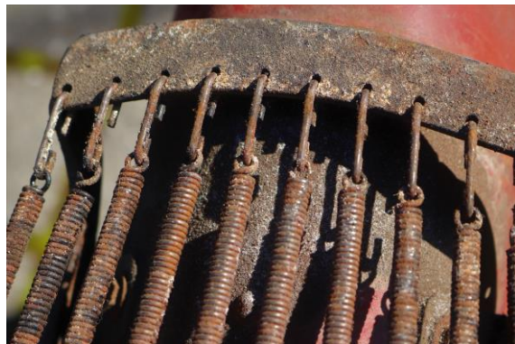
Abb. 45 & 46: Rost und Schimmel unter dem Sattelbezug
