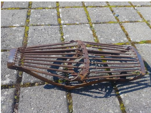
Abb. 45 & 46: Rost und Schimmel unter dem Sattelbezug
