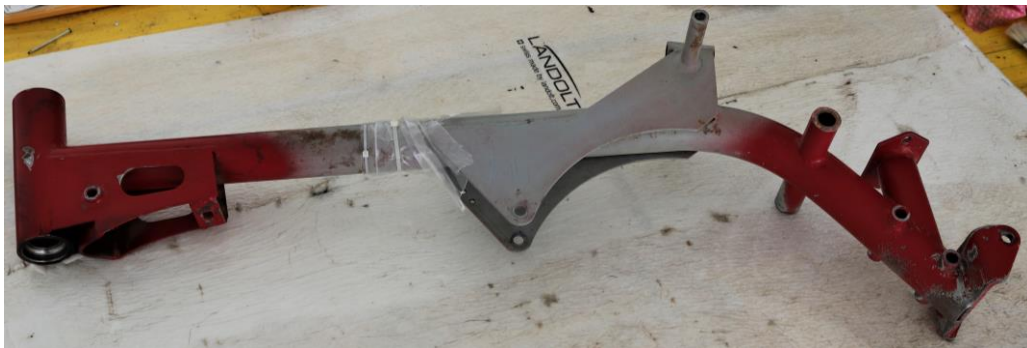
Abb. 54 & 55: Rahmen der Zigolo vor (oben) und nach (unten) der Reinigung
