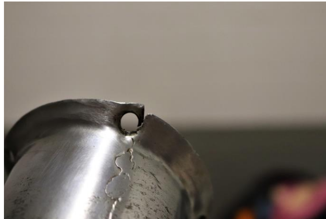
Abb. 43: Schaden am Endtopf
