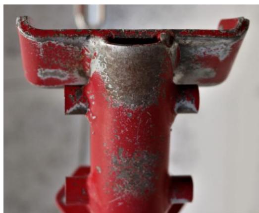
Abb. 56 & 57: Rahmen der Zigolo vor (links) und nach (rechts) der Behandlung mit Owatrol
