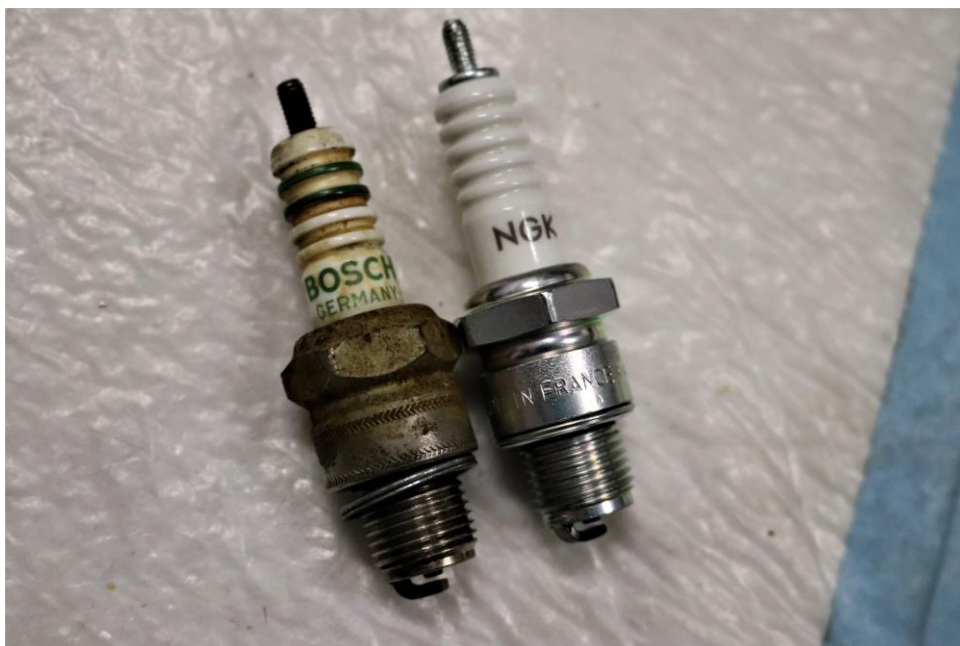
Abb. 49: Alte (links) und neue (rechts) Zündkerze
