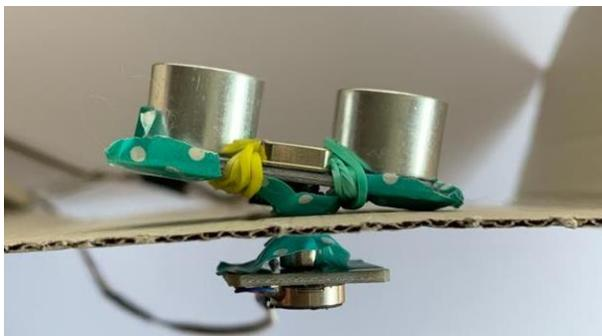
Abbildung 5 Befestigung des Sensors und Motors durch Magnete
