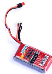
Abb. 20: 500mAh 3S Lipo (für den Flugcomputer) (Abmessungen: 59 x 31 x 12 mm)
