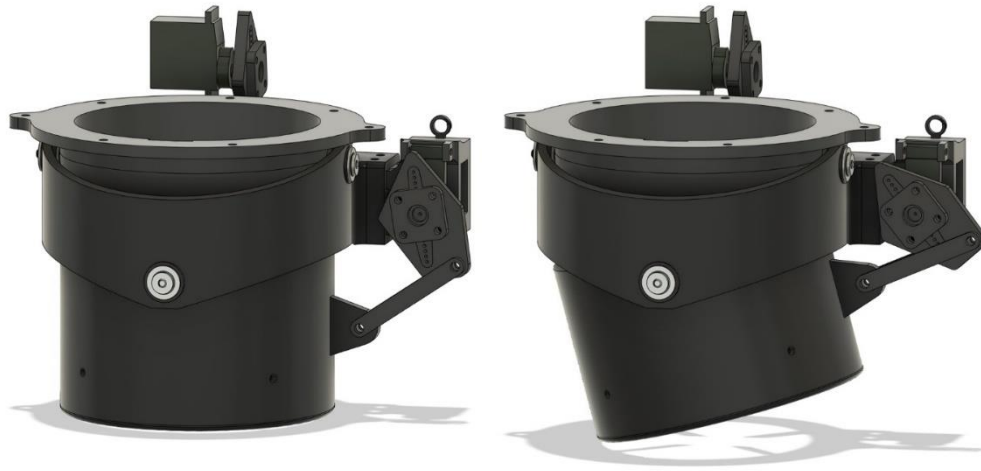
Abb. 36: Düse im Normalzustand (links) und 15° mithilfe des unteren Servos ausgelenkt (rechts)
