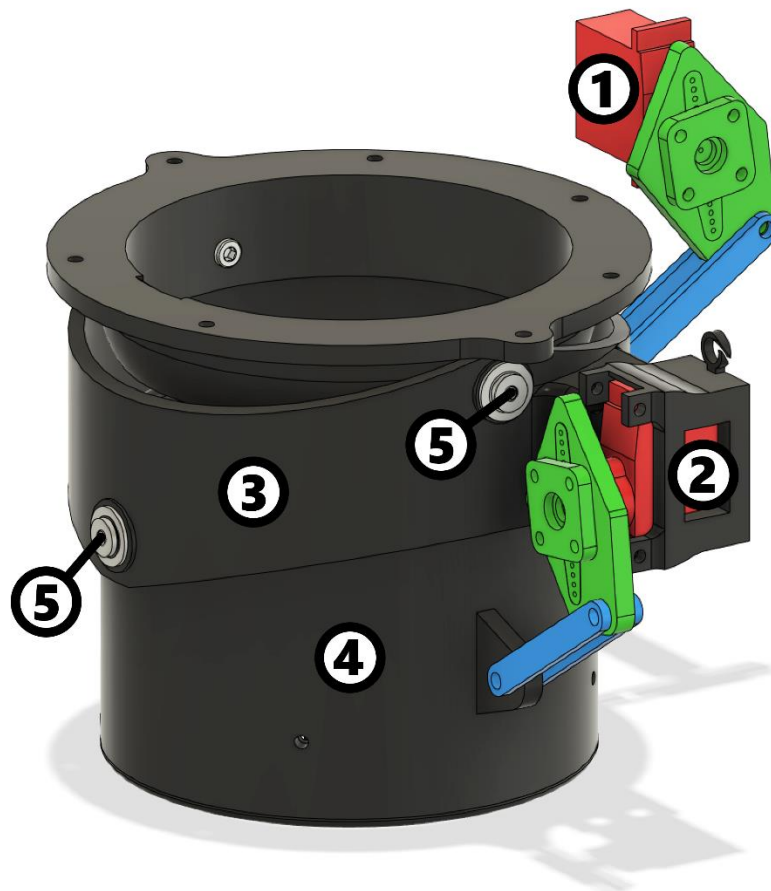
Abb. 33: Düse mit Servomotoren und TVC-Mechanismus (rot/grün/blau eingefärbt)
