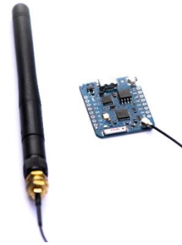
Abb. 19: WeMos D1 Mini Pro Microcontroller (rechts) mit externer Antenne (links)
