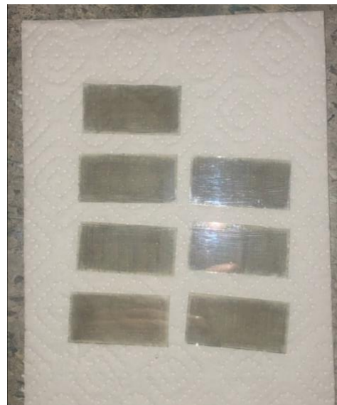
Abbildung 8 Für die Herstellung der Gegenelektroden werden FTO-Glasplatten mithilfe eines Bleistiftes mit Graphit beschichtet.
