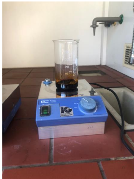
Abbildung 7 Zur Herstellung des Elektrolyten E4 wird mithilfe des Magnetrührkernes Eisen(III)-chlorid in Ethanol gelöst.
