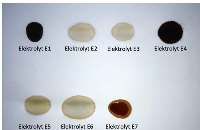
Abbildung 19 Farbe der Elektrolyten. Man erkennt klar, dass Elektrolyten E4, E1 und E7 die grössten Absorptionen im solaren Spektrum aufweist.
