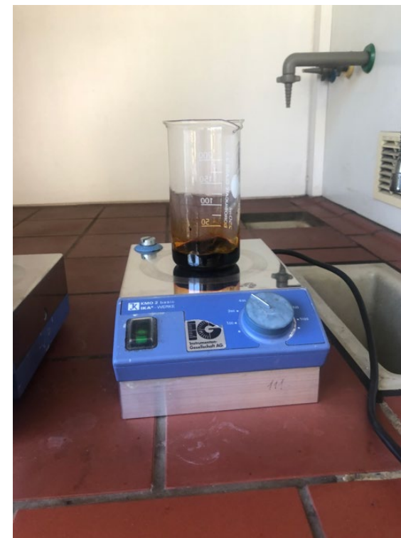
Abb. 1: Zur Herstellung des Elektrolyten E4 wird mithilfe des Magnetrührkerns Eisen(III)-chlorid in Ethanol gelöst. Bildquelle: von der Autorin.
