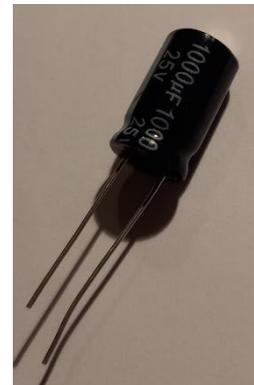
Abbildung 24: Elko - Kondensator
