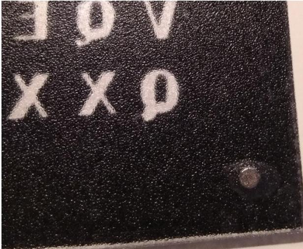
Abbildung 30: Rückseite des Zifferblattes mit der Milchglasfolie und darunter die Magnete
