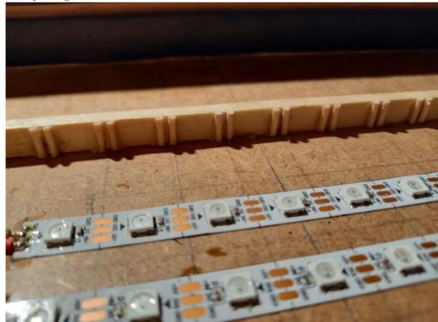
Abbildung 41: Ein kleiner Rahmen mit Kerben wird jeweils rund um die Matrix gebaut.
