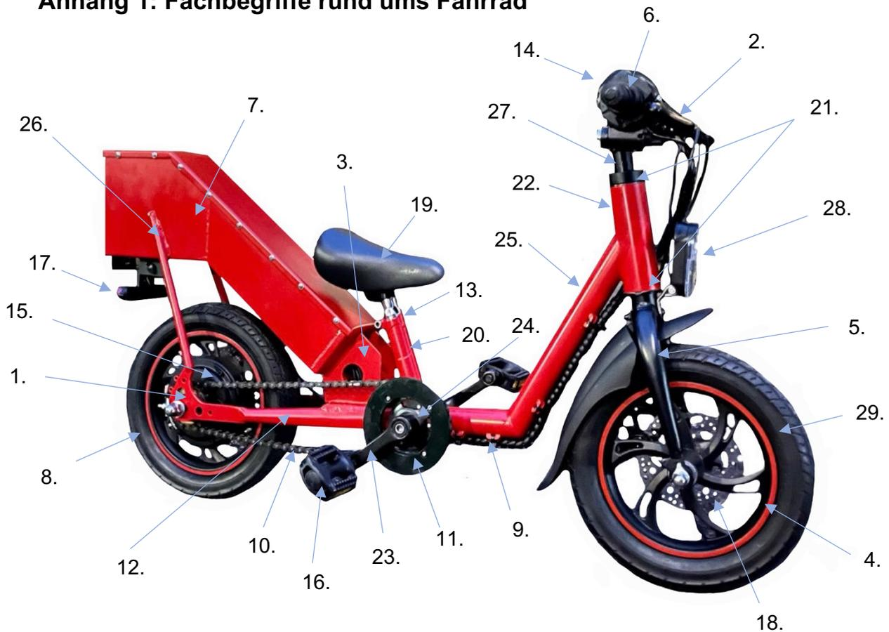
Abb. 15: Aufbau eines Fahrrades mit benannten Komponenten (Eigene Abbildung)
