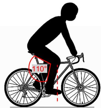
Abb. 4: Optimale Sitzposition bei einem Fahrrad (Canyon Fahrräder Radfahrer, 2021)
