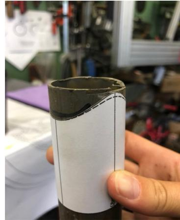
Abb. 6: Unterrohr mit Vorlage für eine Aussparung (Eigene Abbildung)
