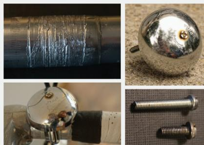
Ein Beispiel: Um die beschädigte Stelle am Lenker zu überdecken, habe ich nach einer passenden secondhand Klingel gesucht. Mit Hilfe einer längeren Schraube habe ich diese Klingel an der optimalen Stelle am Lenker angebracht (Abb.3).
