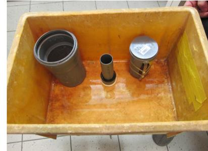
Abbildung 5 Modell für den Bau eines Glockensiphons
