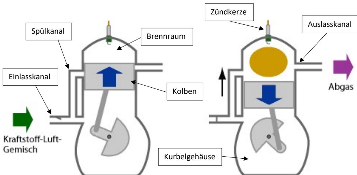
Quelle: In Anlehnung an Paschotta, RP-Energie-Lexikon, Zweitaktmotor, 2020
