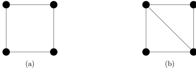
Abb. 10: Eine durch vier Kanten begrenzte Fläche kann in zwei durch drei Kanten begrenzte Flächen geteilt werden.
