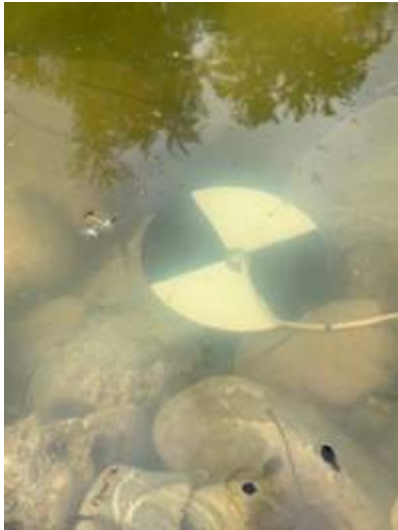
Abb. 17: Secchi-Scheibe aus einer alten CD
