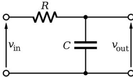
Abbildung 5: RC Low-Pass Filter
