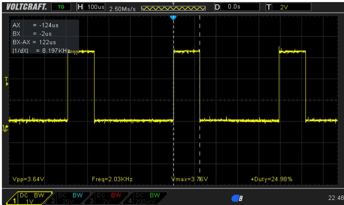
Abbildung 16: Signal für die Motoren(25% PWM).
