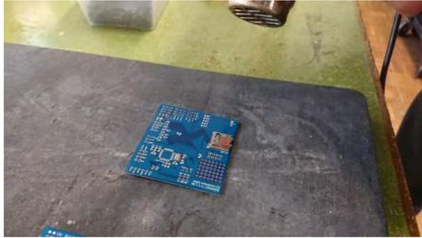
Abbildung 11: Löten des Quarzes und des microSD-Karten Slots
