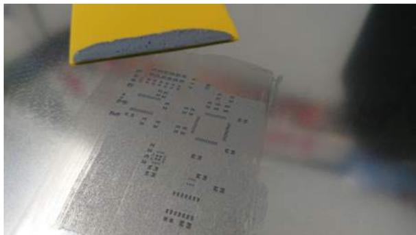
Abbildung 12: Mit Hilfe des Spachtel und der Schablone aufgetragene Lötpaste.
