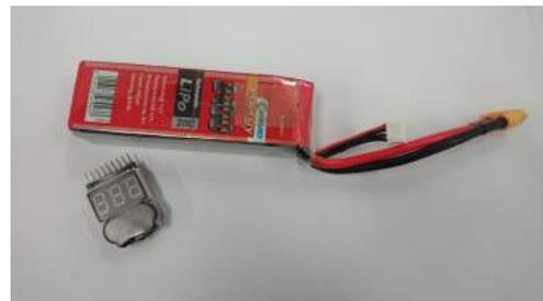
Abbildung 6: LiPo-Akku und Akkuüberwacher
