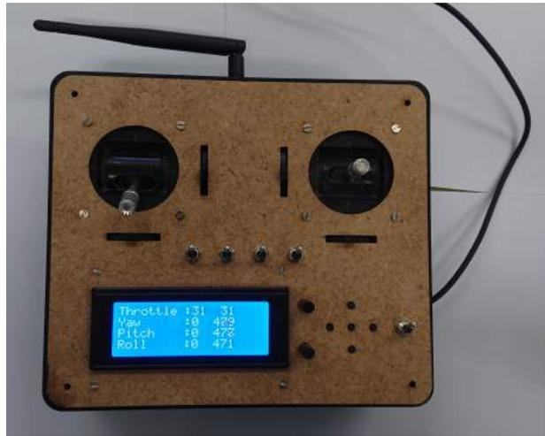
Abbildung 17: Fernbedienung mit Schiebereglerausgabe auf dem Display.
