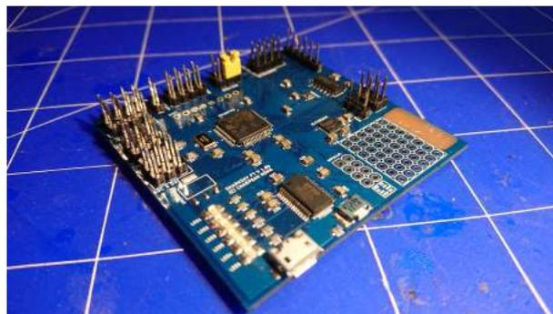
Abbildung 15: Fertiges Flightcontroller Board
