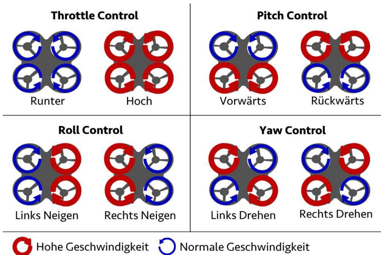
Abbildung 2: Drehrichtung und Schub bei verschiedenen Steuereingaben
